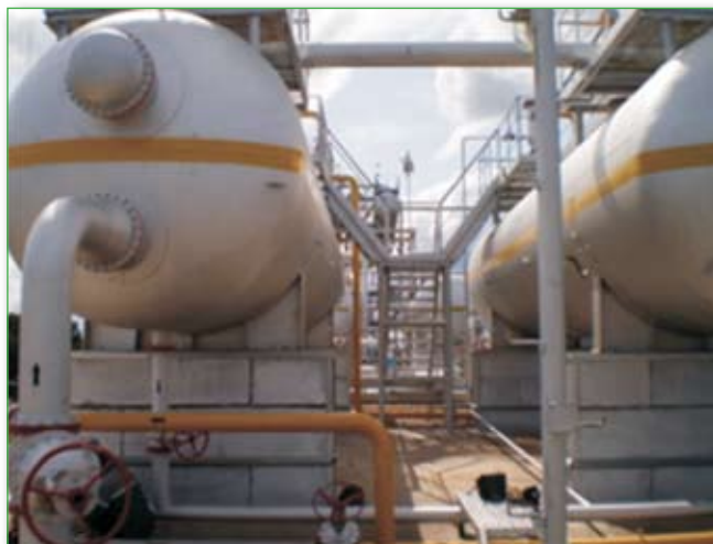
Учет ПНГ в одном из подразделений «Татнефти» на выходе из сепараторной установки
