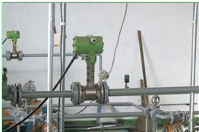
Измерение расхода газа в установках по переработке нефти возложено на вихревые расходомеры ЭМИС-ВИХРЬ
