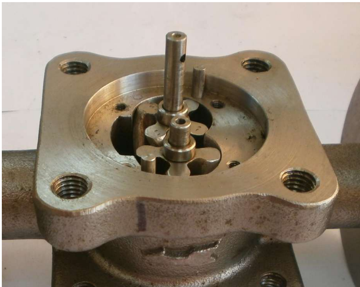
Рисунок 3.2 – Правильное расположение роторов относительно друг-друга
