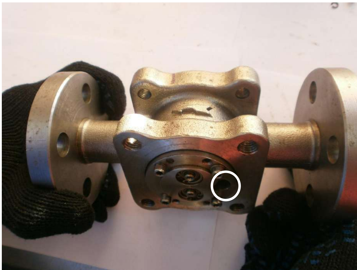
Рисунок 3.5 – Отверстие на нижней крышке
