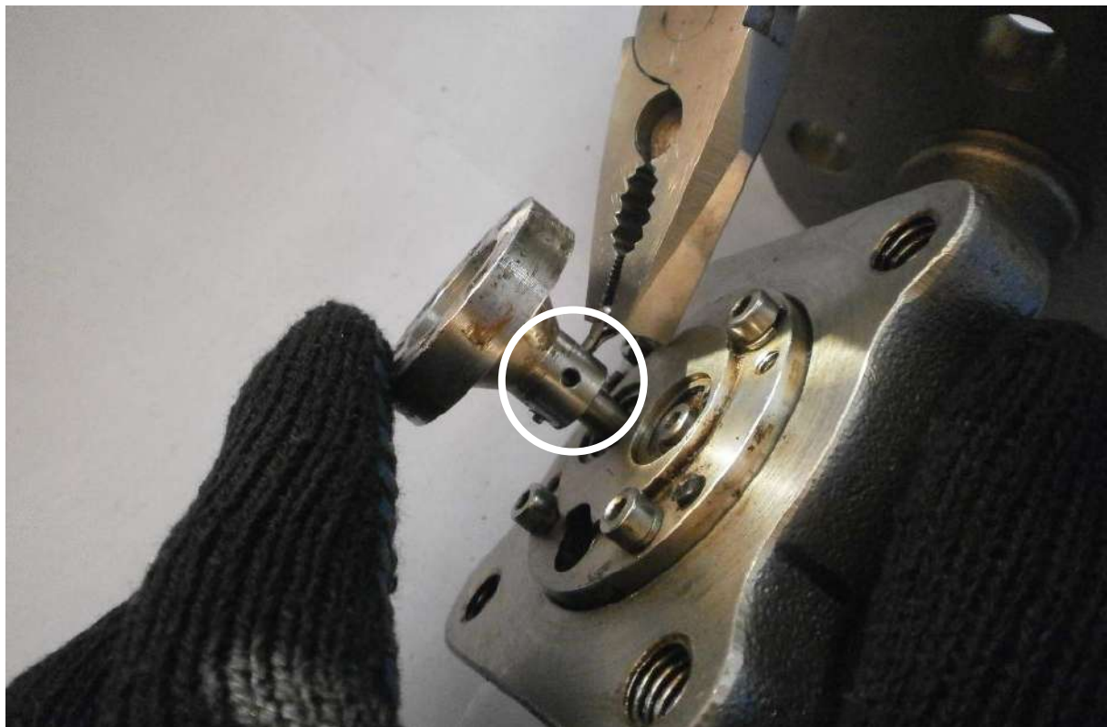
Рисунок 3.7 – Установка фиксирующего штифта
