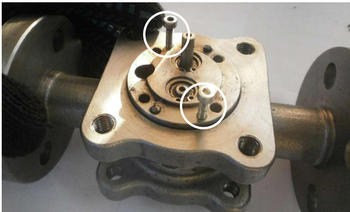
Рисунок 2.4 – Снятие верхней крышки
