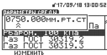
Состав изменяемых параметров для газовых смесей и нефти аналогичен составам, описанным в п.2.3.3. Порядок просмотра и изменения аналогичен описанному в данном пункте примеру изменения параметра барометрического давления.
