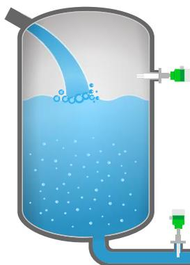
**Рисунок. 2.2 - Монтаж сигнализатора в зоне струи наполнения**
