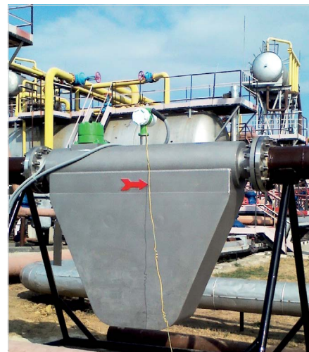
Рис. 2 а — Массовый расходомер ЭМИС-МАСС 260 Ду 200 в установках подготовки нефти
